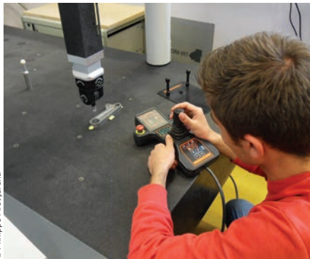
Un étudiant du BTS CPRP réalisant le contrôle MMT d'une pièce.
