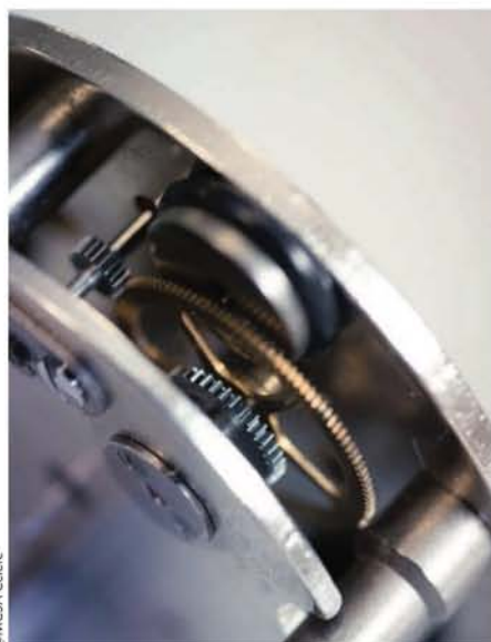
Le taillage d'engrenage petit module requiert une précision au micron près... Et un contrôle en conséquence !
